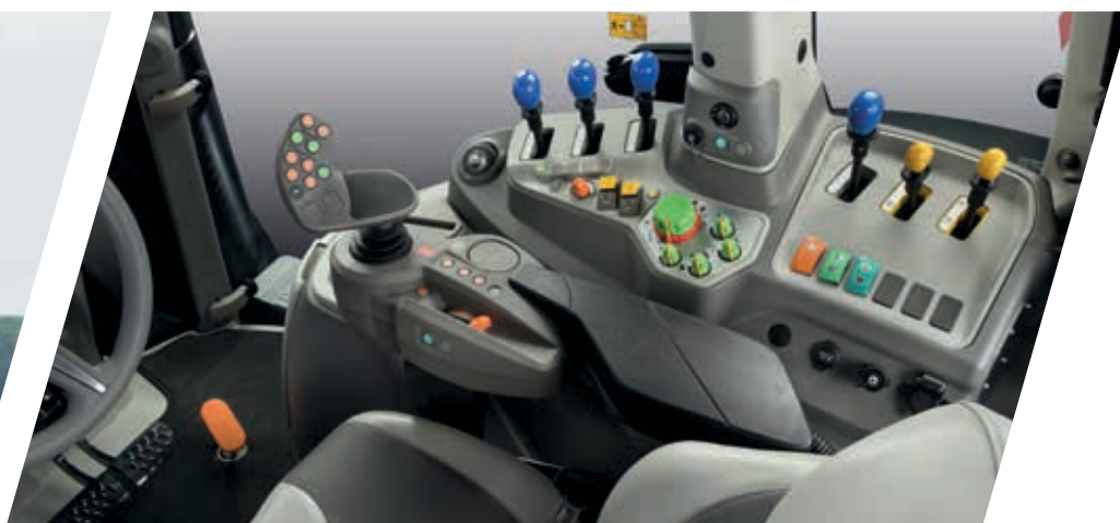
> Equipamento da cabina MaxiVision com distribuidores traseiros totalmente mecânicos em combinação com transmissão Powershift (imagem grande) e RCshift (imagem acima)
