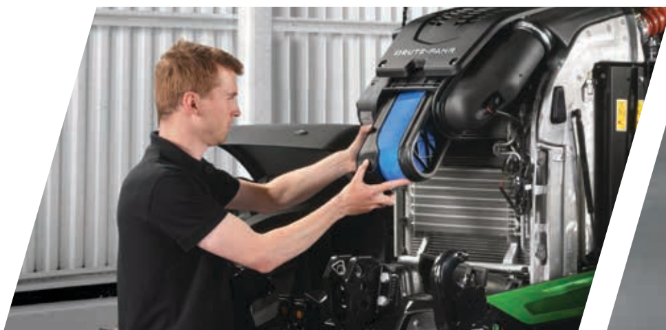
> Todos os modelos estão equipados com um filtro de ar PowerCore, para uma longa vida útil.
